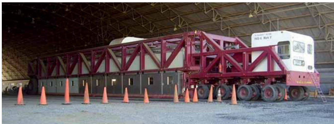
US Corps of Engineers Engineering and Development Center udfører accelererede fuldskalaforsøg med belægninger på Tensar MSL.
